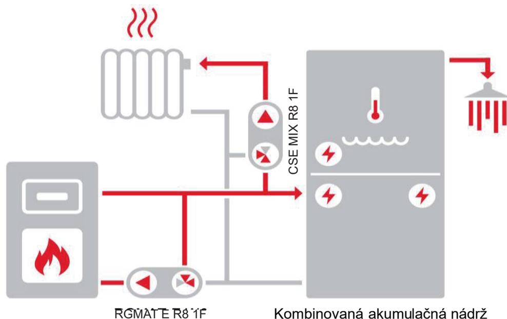
Schéma zobrazuje typické zapojenie kotla na tuhé palivá, kombinovanej akumuláčnej nádrže (s možnosťou prípravy ohriatej pitnej vody) a vykurovacieho okruhu (s odporúčanou čerpadlovou skupinou CSE MIX R8 1F - nie je súčasťou dodávky).
