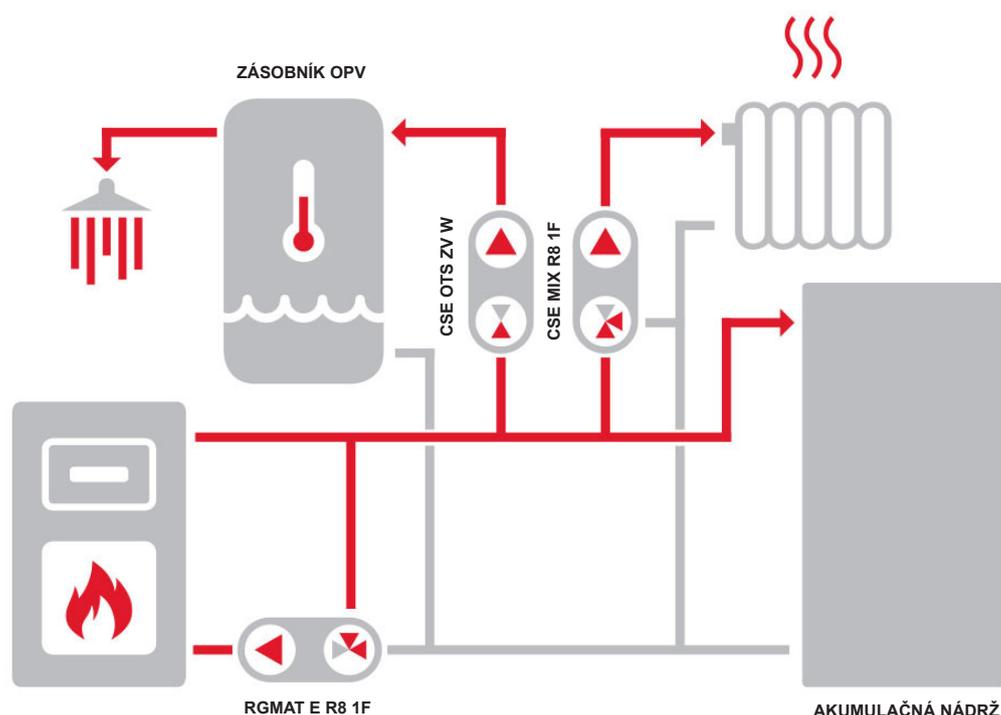
Schéma zobrazuje typické zapojenie kotla na tuhé palivá, akumuláčnej nádrže a vykurovacieho okruhu (s odporúčanou čerpadlovou skupinou CSE MIX R8 1F - nie je súčasťou dodávky). Ak je kotol využívaný taktiež pre prípravu OPV, odporúčame inštalovať čerpadlovú skupinu CSE OTS ZV W (nie je súčasťou dodávky).
