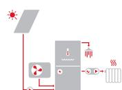
Solárny systém s kombinovanou akumulačnou nádržou HSK pre prípravu ohriatej pitnej vody a prikurovanie, pre systémy s tepelnými čerpadlami
