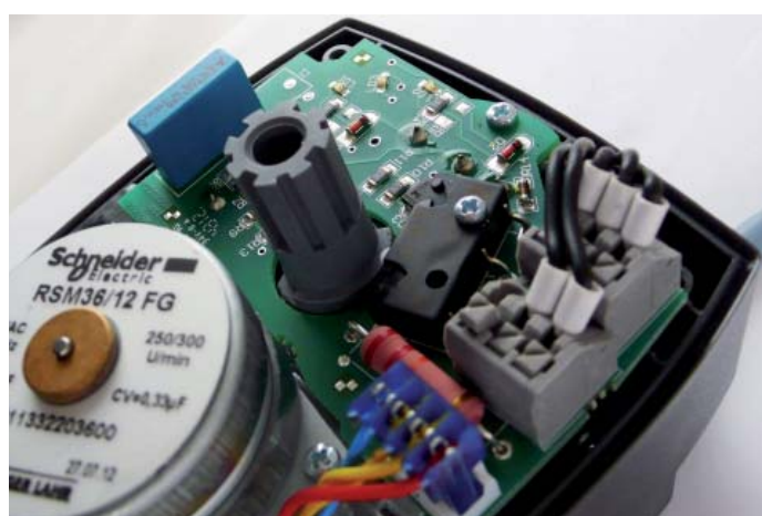
12. Vybrať krúžok s osadením pre spínanie mikrospínača.
