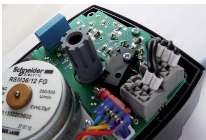
27. Vybrať krúžok s osadením pre spínanie mikrospínača.
