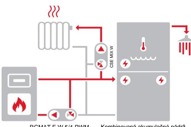
Schéma zobrazuje typické zapojenie kotla na tuhé palivá, kombinované akumulačné nádrže (s možnosťou prípravy ohriatej pitnej vody) a vykurovacieho okruhu (s odporúčanou čerpadlovou skupinou CSE MIX W - nie je súčasťou dodávky).
