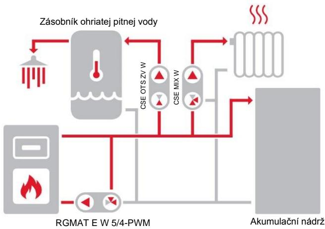
Schéma zobrazuje typické zapojenie kotla na tuhé palivá, akumulačné nádrže a vykurovacieho okruhu (s odporúčanou čerpadlovou skupinou CSE MIX W - nie je súčasťou dodávky). Ak je kotel využívaný taktiež pre prípravu OPV, odporúčame inštalovať čerpadlovú skupinu CSE OTSZV W (nie je súčasťou dodávky).
