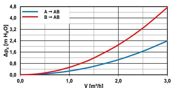
V priebehu zmiešavania sa tlaková strata ventilu pohybuje medzi krvkami v závislosti na zmiešavacom pomere
