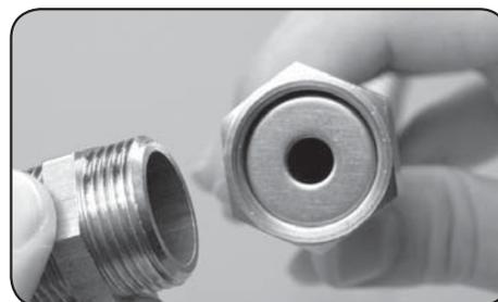
Prevlečnú maticu podržte kliešťami alebo zľahka upnite do zveráka. Veľkú podložku vložte do prevlečnej matice.
