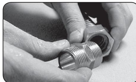
Do prevlečnej matice zaskrutkujte vhodné šrúbenie (napr. šrúbenie s vonkajším závitom alebo šrúbenie so zvieracím spojom).
