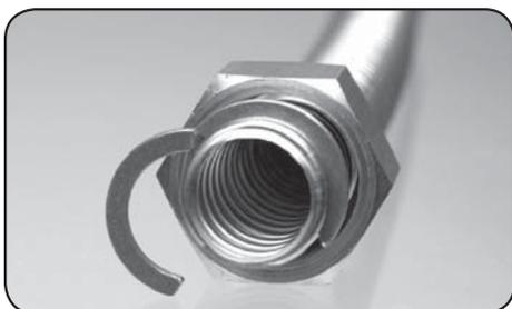
Na rúrku nasuňte prevlečnú maticu, do prvej vlnky vložte zvierací mesiacik a zaklapnite.
