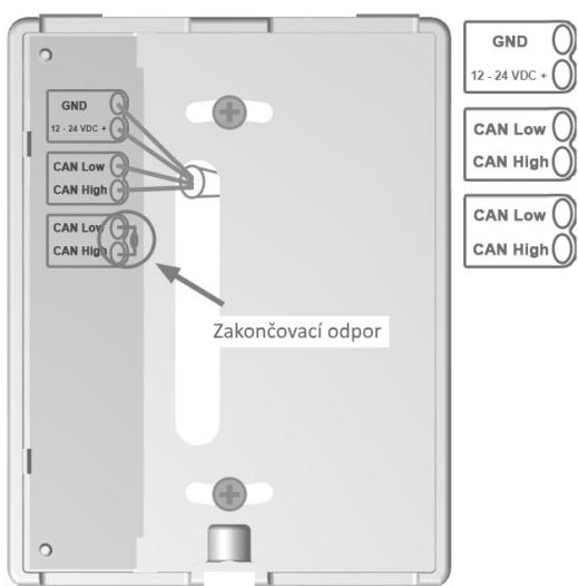
Otvorte svorky pomocou priloženého nástroja a zapojte elektrické káble podľa popisu.
