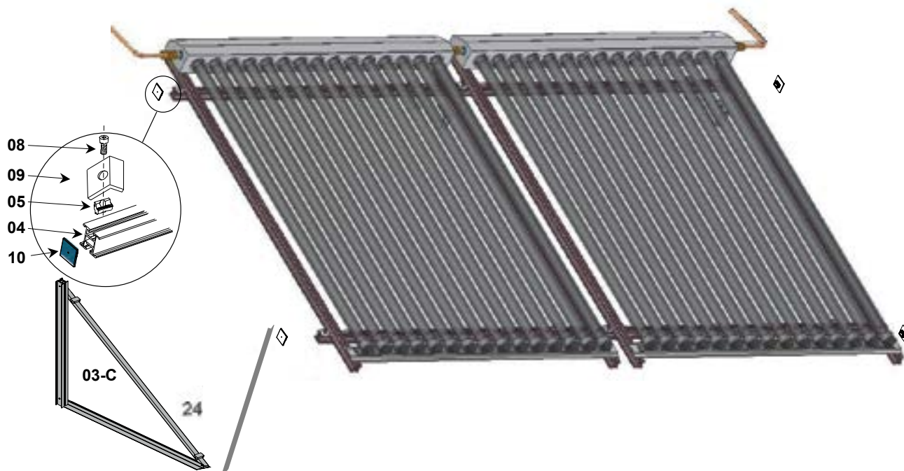
Obr. 15: Trojuholníková podpera a zavetrovací vzpera
